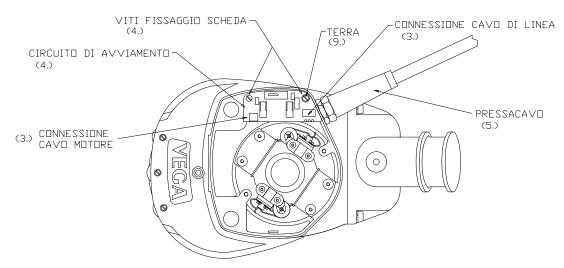
Connessione cavo motore = Motor cable connection Circuito di avviamento = Starting circuit Viti fissaggio scheda = Screws which fix the card
